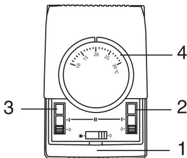
Нижний переключатель (1) имеет два положения: правое положение – отключение вентилятора, левое положение – включение вентилятора прибора.
