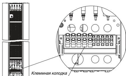
Подключение к электросети осуществляется через автоматический выключатель в соответствии с «Правилами устройства электроустановок». Автоматический выключатель сети потребителя должен обеспечивать полное снятие питающего напряжения с изделия.
